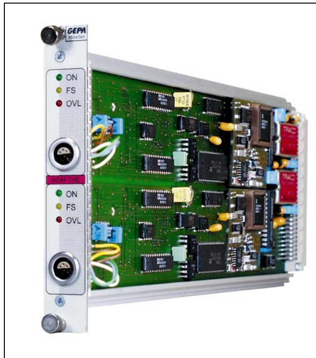
MOM-THE Komfort - Thermoelement – Messverstärker Zum Einsatz in mobilem und stationären Sensorkonditionierungssystem MOM
